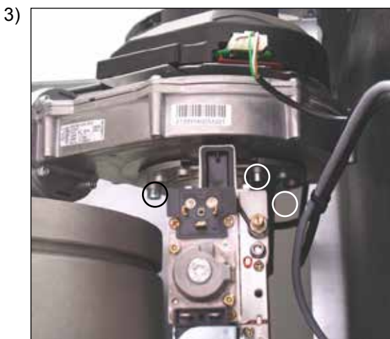
Λύστε τον θάλαμο ανάμιξης από τον ανεμιστήρα (3 τεμ. βίδες άλλην 5mm) και ίσως να τραβήξετε και τον αγωγό αναρρόφησης αέρα.
