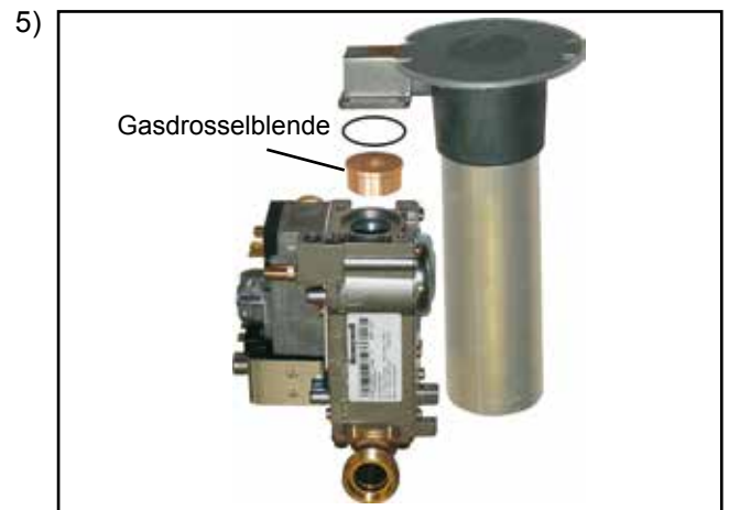
Eingebaute Gasdrosselblende entfernen und durch die für die neue Gasart bestimmte Gasdrosselblende (nach Tabelle Seite 25) ersetzen.
