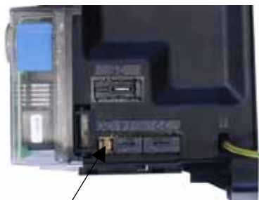
Alzare la copertura della presa ad innesto 20 utilizzando un cacciavite oppure una pinza universale
