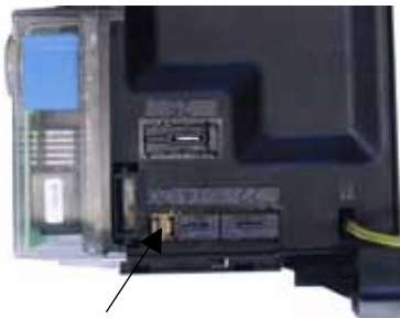
Abdeckung Steckplatz 20 mit Schraubendreher oder Kombizange ausbrechen
